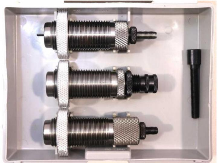
RCBS Matrizensatz 3-teilig, Hartmetallsatz für Kaliber .41 Magnum, bestehend aus Aufweit-, Setz- und Kalibriermatrize mit Hartmetalleinsatz, 2 Setzstempel für RN- und SWC-Geschosse, in Originalbox, Zustand 2
