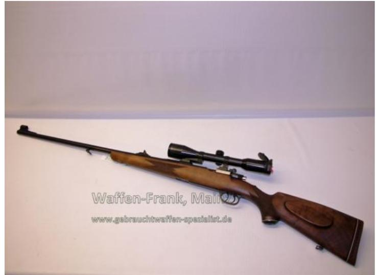
Lfl. 65 cm, Bj. 1995, verbessertes Mauser-System, mit flach geschmiedetem Kammerstengel und Sicherung auf der Scheibe, deutscher Stecher, aufklappbarer Magazindeckel, EAW-Schwenkmontage mit ZF Kahles Helia S 6x42 / A 1, klassische Schäftung mit deutscher Backe für Rechtsschützen, Schaftlänge einschl. Gummikappe 370 mm ..... mit der am 'mildesten' zu schießenden Magnumpatrone für Hochwild bis 300 m (passende Munition und Wiederladezubehör dafür günstig ab Lager lieferbar).....
